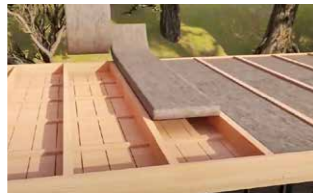
ISOLATIE Dakpanelen zijn standaard voorzien van isolatie. Wanden en vloeren zijn ook te voorzien van isolatie
